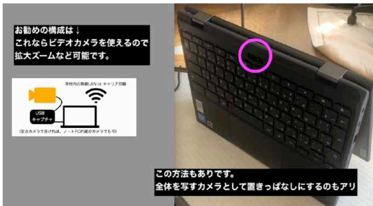
USBキャプチャーデバイスを追加すれば、学校にあるビデオカメラを接続させる事ができます。この方法の方が映像に自由度が出ます。ピントのあい方が内蔵カメラより断然ビデオカメラの方が良いので、お勧めはUSBキャプチャーデバイスの利用です。（一眼デジカメなどは雰囲気が出てさらに劇的に映像が変わります）
